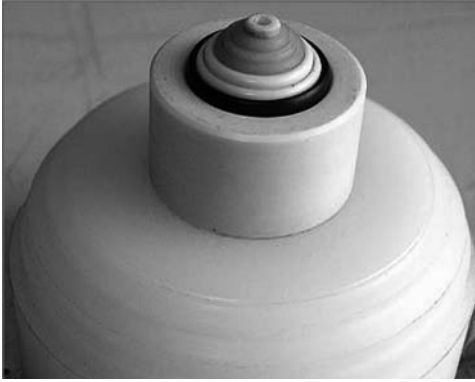
FIG. 6. Un display aptico di tipo CASR per un singolo polpastrello [1].
