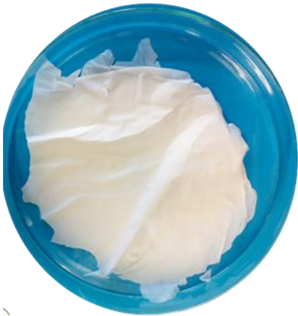
Membrane con spessore 10-100 \mu\text{m} Diametro delle fibre 0.1-10 \mu\text{m}
