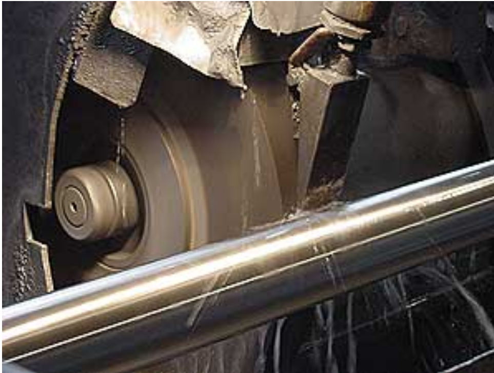
Rettifica in passante di barre cilindriche
